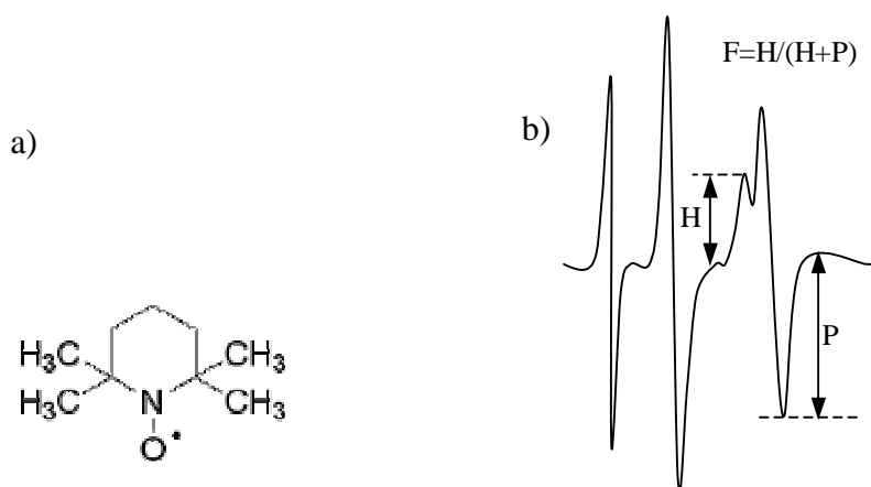
Rys. 27. Wzór strukturalny sondy TEMPO a), oraz widmo EPR uzyskane przy zastosowaniu tej sondy rozpuszczonej w lecytynie jajecznej, z której wykonana została następnie dyspersja liposomów b).
