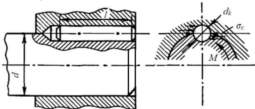
Fig. 3.25. Tenon groove connection
