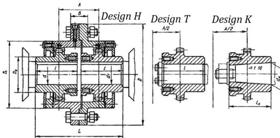
Fig. D.14. Gear couplings (ISO-R773)
