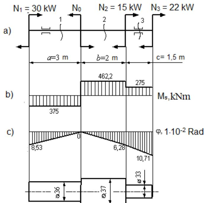
Fig. 2.13. Shaft load diagram:
