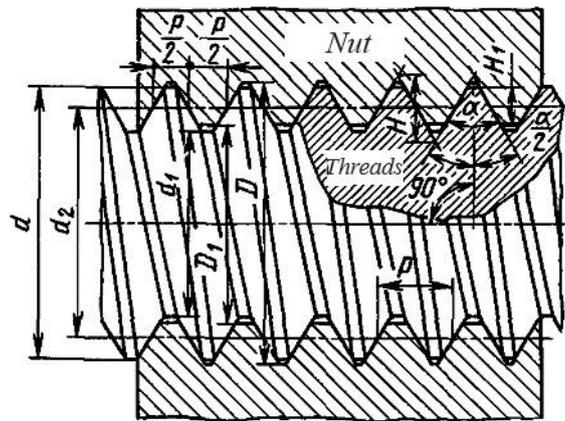
Fig. 3.12. Basic thread parameters
