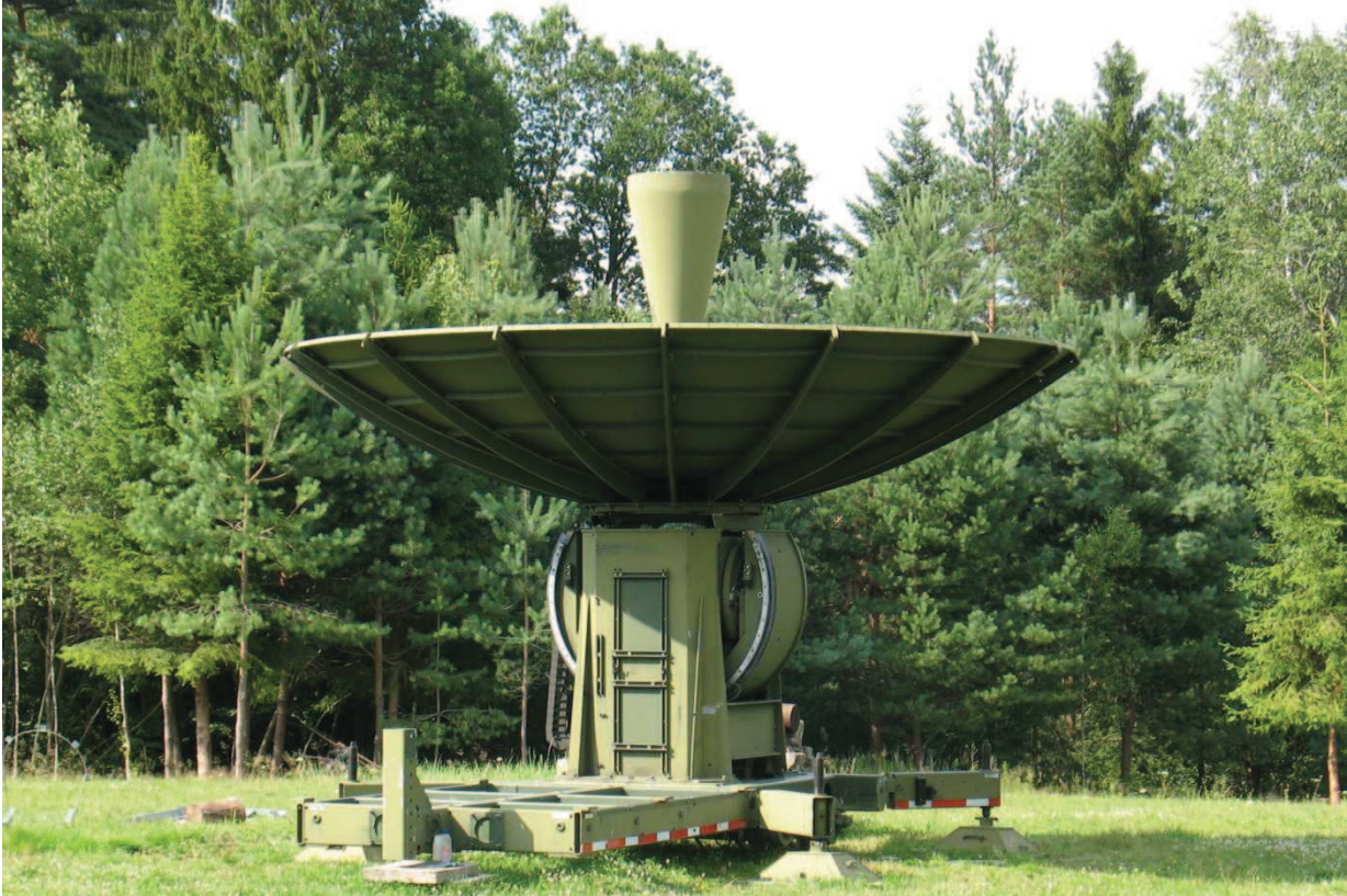
Fot. 10. Widok na RFT-5.4 w Rzepienniku Biskupim po zamontowaniu czaszy.
