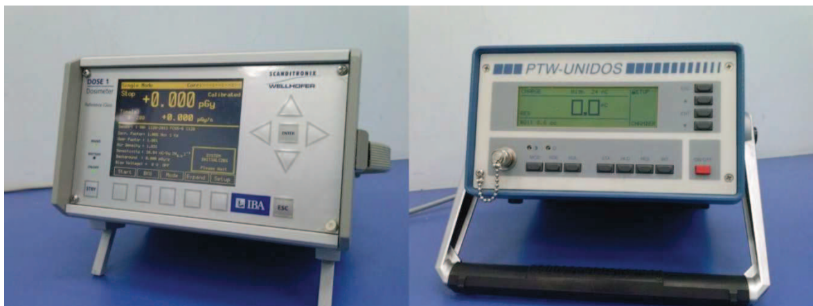
Rys. 17. Elektrometr do pomiaru dawki, DOSE1 firmy Scanditronix Wellhofer oraz UNIDOS firmy PTW.
