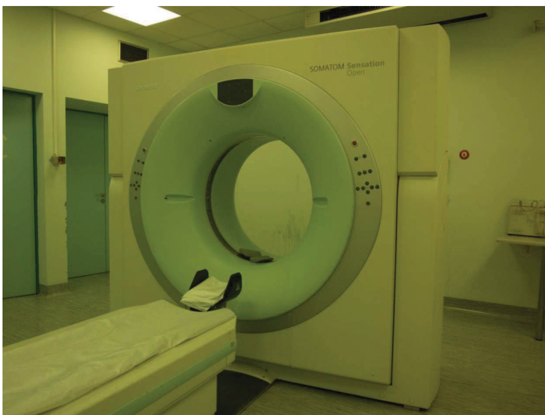
Rys. 2. Tomograf komputerowy firmy Siemens Somatom Sensation Open. Tomograf posiada lampę/generator Straton o napięciu lampy 80, 100, 120, 140 kV ( \pm 10\% ) oraz zakresem natężenia prądu w zakresie 28-400 mA. Aparat posiada detektor 20 rzędowy, co stanowi 1344 \times 20 kanałów pomiarowych. Aparat umożliwia wykonanie skanów poprzecznych co 1.5 mm. Średnica gantry jest powiększona do wartości wynoszącej 82 cm oraz z możliwością nachylenia 30^\circ . Laser zamontowany w urządzeniu do pozycjonowania pacjenta pracuje z dokładnością 1 mm.
