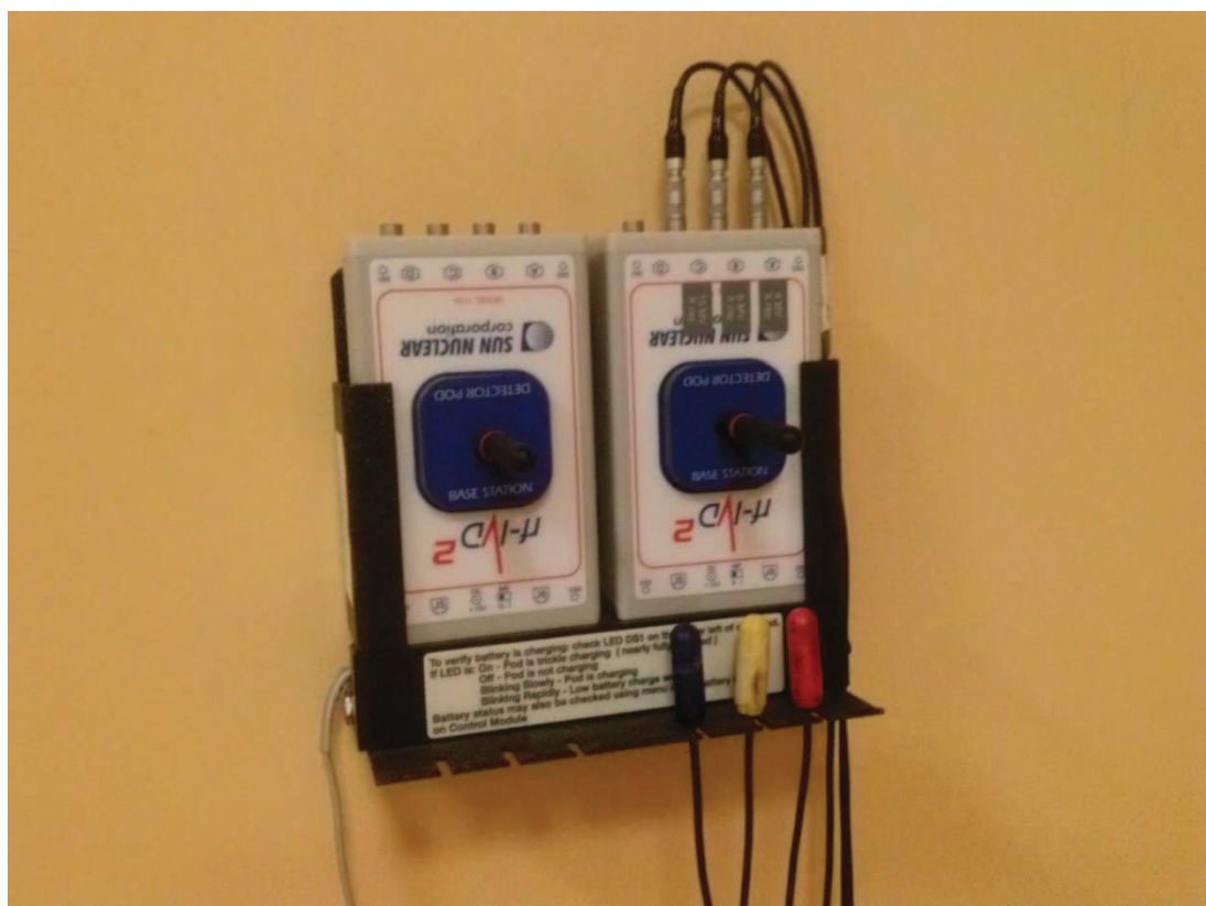
Rys. 15. Dioda IsoRad wraz z zamontowanym bezprzewodowym zestawem do przeprowadzenia dozymetrii in vivo.
