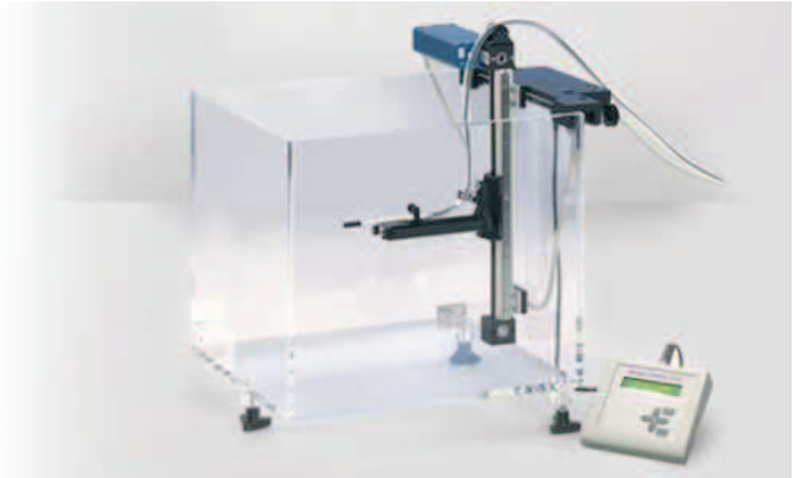
Rys. 20. Mały fantom wodny WP 1D wraz z manipulatorem do sterowania ruchem detektora góra-dół.
