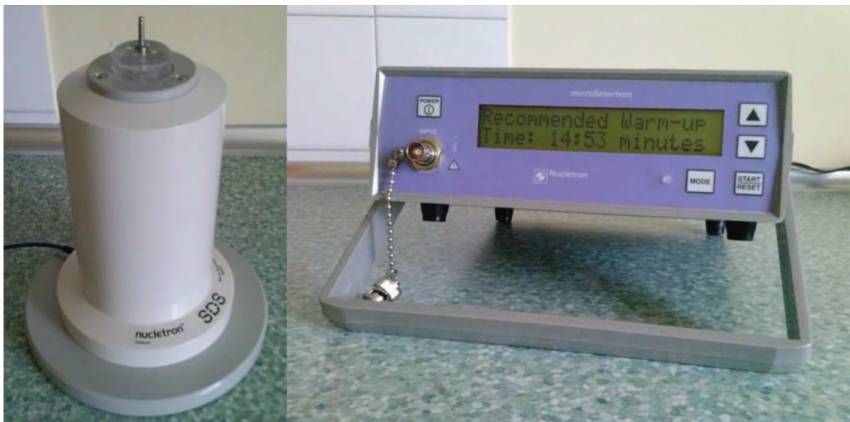
Rys. 21. Komora studzienkowa oraz elektrometr firmy Nucletron.
