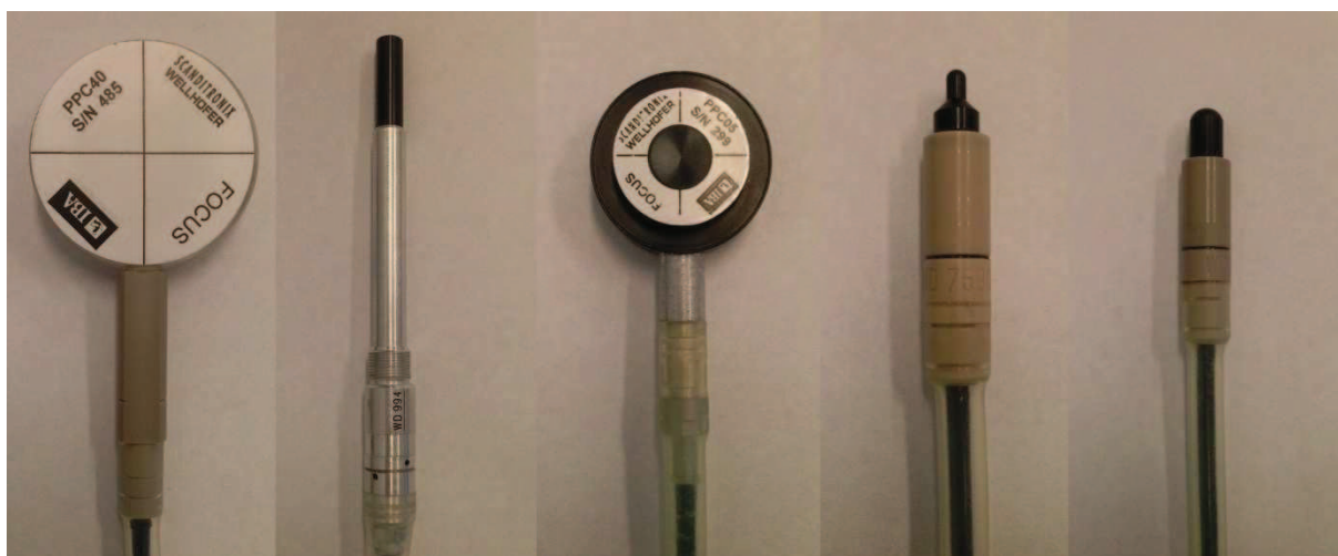
Rys. 11. Komory jonizacyjne firmy IBA (Scanditronix Wellhofer): PPC40, FC65-G, PPC05, CC01, CC13.
