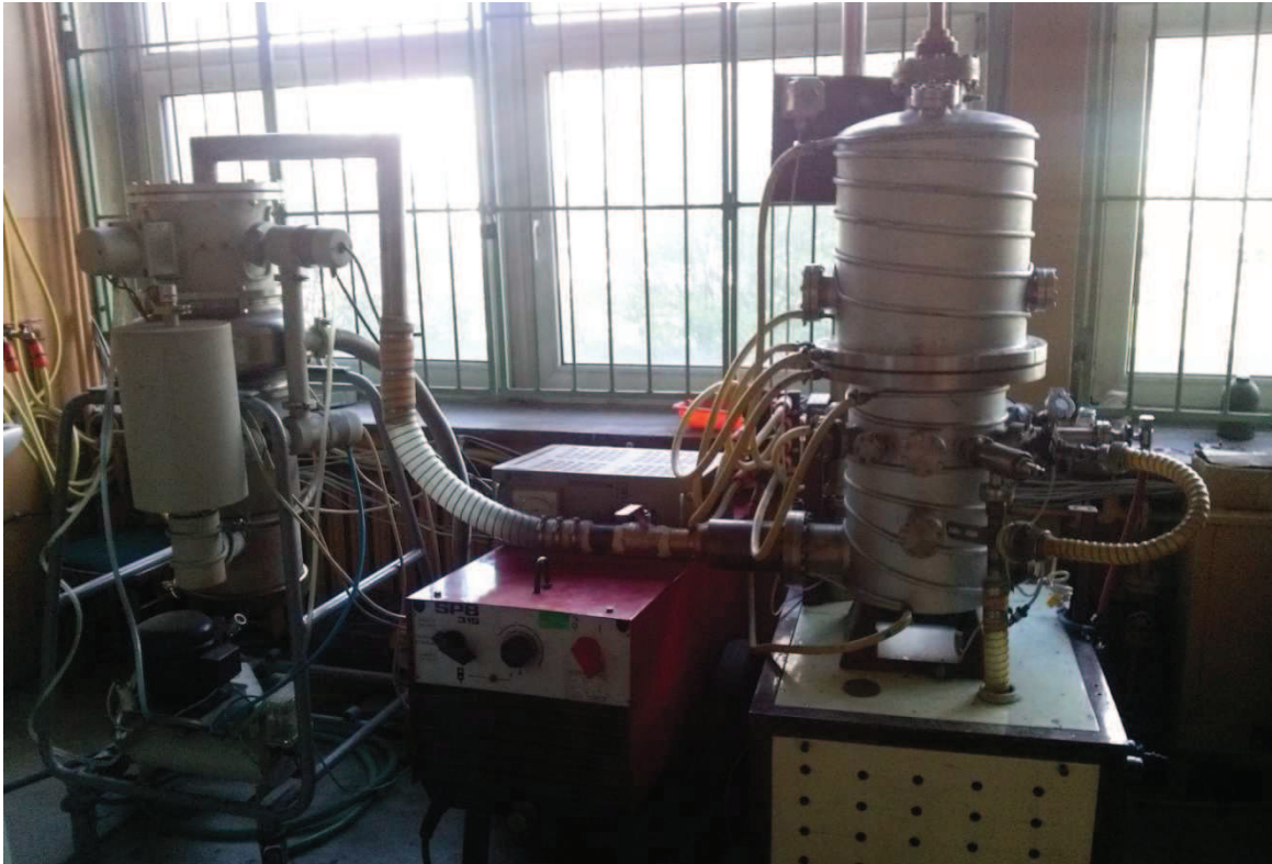
Rys. 5. Widok ogólny układu pieca łukowego z dołączoną pompą dyfuzyjną.
