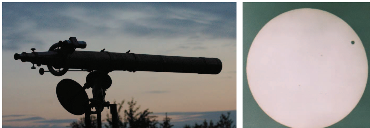
Rys. 13. Luneta Metlera i wykonane przez nią pierwsze zdjęcie tranzytu Wenus, jeszcze z chmurami w roli filtru. Złota Góra, 6 czerwca 2012. (fot. B.Wszolek)
