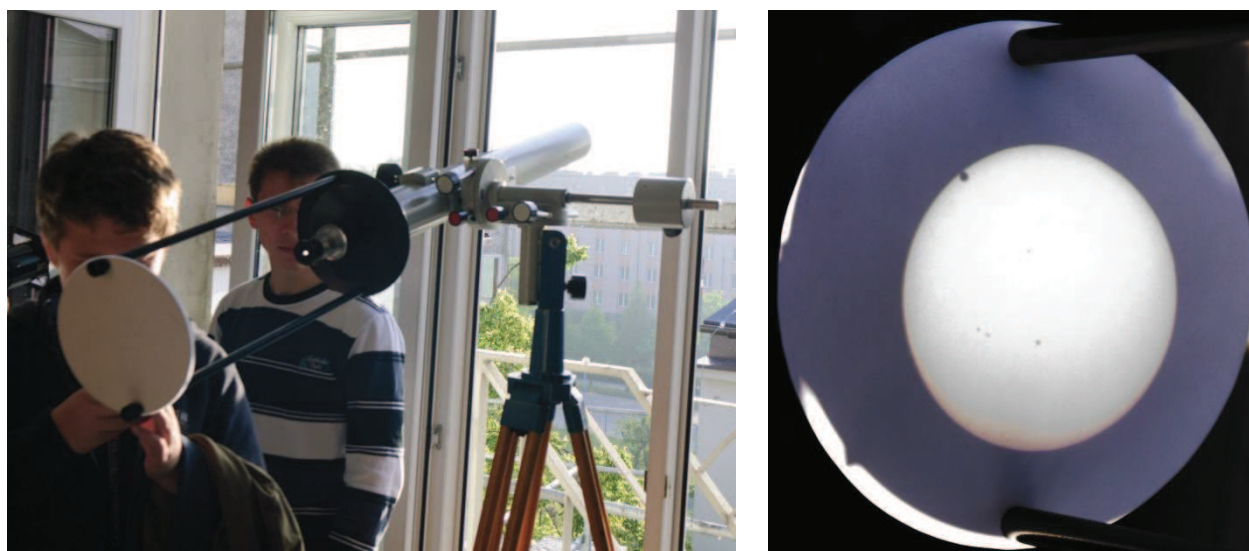
Rys. 10. Obserwacje tranzytu Wenus metodą projekcji okularowej prowadzone na drugim stanowisku obserwacyjnym. (fot. M.Gonera)
