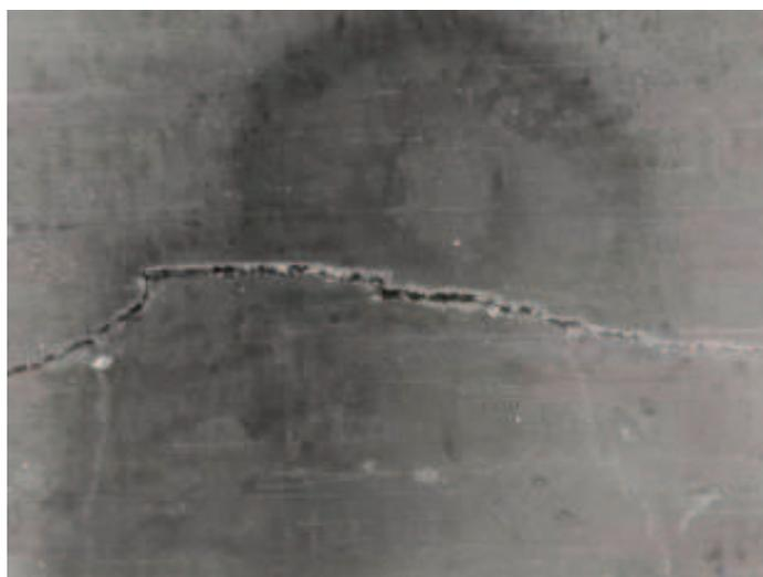
Рис. 2. Характер усталостного разрушения поперечины.
