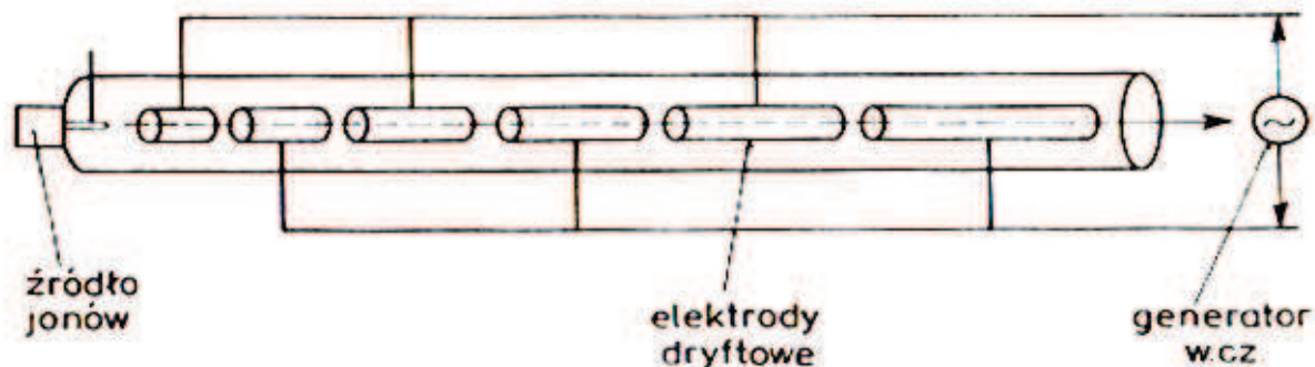
Rys. 1. Schemat budowy struktury Wideroe.
