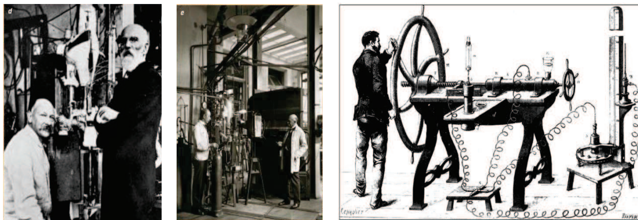
Rys. 2. Nowoczesne laboratorium kriogeniczne Kamerlingha Onnesa w Lejdzie, które stanowiło jakościowy skok w uprawianiu fizyki doświadczalnej, w porównaniu do aparatury Cailleteta do skraplania gazów z roku 1878 [ http://bern-1914.org/genf_1896/rp11_sa_cailletet.html ]. Kamerlingh Onnes (na lewo) z Johannes Diderik van der Waalsem i z technikiem Giles Holstem, który wykonywał pomiary [3, 4].
